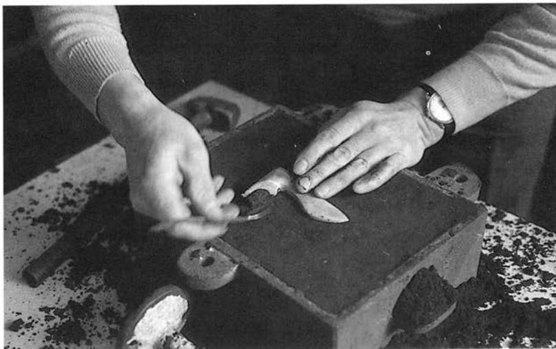
Abb. 12 Das hölzerne Axtmodell in dem mit Sand gefüllten unteren Formkasten. Im Schaftloch steckt ein Tonkern. Dieser bildet das Schaftloch und muß nach dem Guß herausgemeißelt werden.
