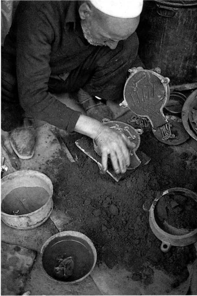
Abb. 5 Nach Öffnen der beiden Formhälften werden die eingedrückten Objekte entfernt.
