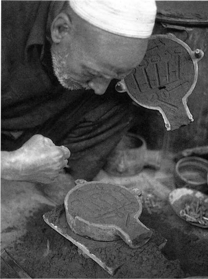
Abb. 8 Die fertige Sandform. In der oberen Formhälfte ist der Einlaß des Gußtrichters zu erkennen.
