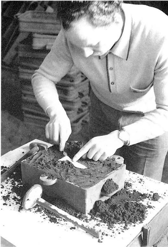
Abb. 11 Metallgießerei in Bonn. Das hölzerne Modell einer frühdynastischen Schaftlochaxt wird abgeformt.
