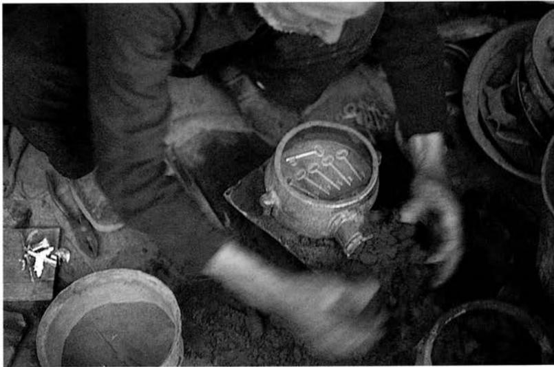
Abb. 3 Der aufgesetzte obere Formkasten wird mit Sand gefüllt.
