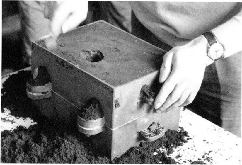
Abb. 15 Der obere Gußkasten mit seiner verdichteten Sandfüllung wird abgenommen. Das Rohr ist entfernt. Zu erkennen ist der Gußtrichter.
