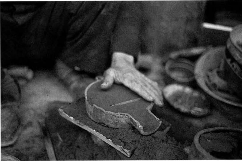
Abb. 2 Die Patrizen (Schlüssel und ein Bandeisen, das die Stelle des späteren Gußkanals einnimmt) werden in den unteren, mit Sand gefüllten Formkasten gedrückt.
