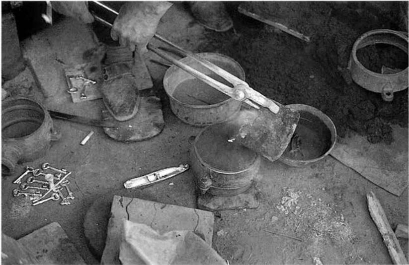
Abb. 9 Geschmolzenes Altmetall wird in die Form eingegossen. Links ist ein fertiger Gußrohling zu erkennen.
