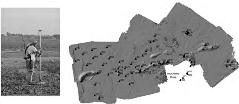
Abb. 2: Aufmessung der Festpunkte durch Philippe Kluge (l.) und fertiges Festpunktnetz mit aus den Luftbildern generiertem digitalem Höhenmodell im Hintergrund (r.).
