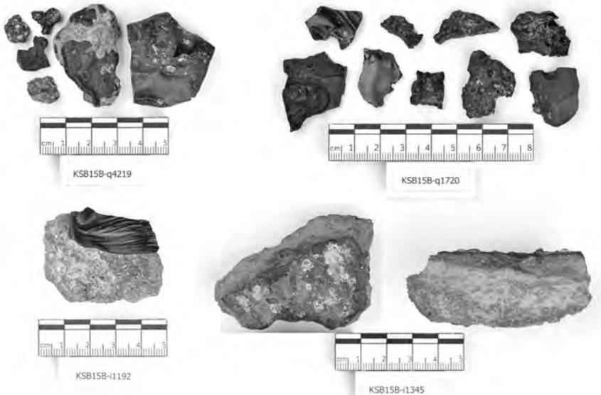
Abb. 6: Beispiele für Schlacke (obere Reihe) und Ofenfragmente mit Anhaftungen von Schlacke (untere Reihe) aus dem Bereich B.
