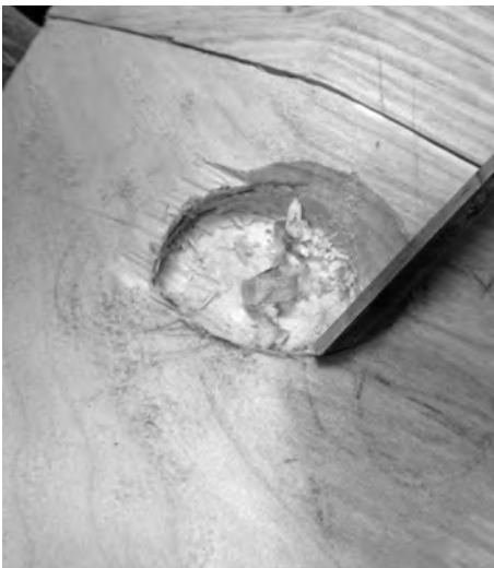
Abb. 26: Ausarbeitung der Löcher an der Unterseite der Tischplatte für die Einpassung der Beine (Foto: M. Scheiblecker).
