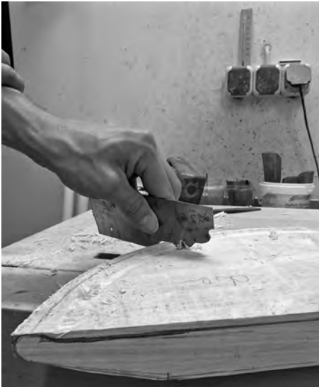
Abb. 23: Formung des erhöhten Randes der Tischplatte mit einer Ziehklänge, die dafür in Form gefeilt wurde (Foto: M. Scheiblecker).
