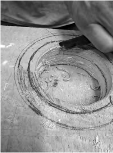
Abb. 25: Anpassung des Ringes für die Beine, dazu Ansträgen der oberen und unteren inneren Ränder, an denen die Beine aufliegen (Foto: M. Scheiblecker).
