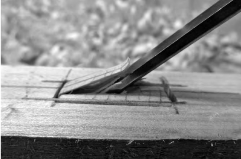
Abb. 19: Das Ausstemmen der Zapfenlöcher für die Flachdübel erfolgte mit Stemm- und Stecheisen (Foto: M. Scheiblecker).
