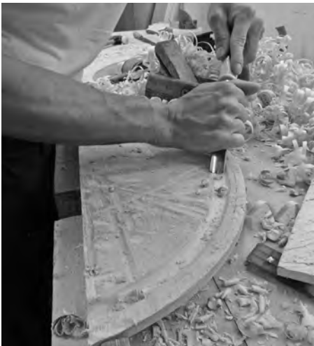
Abb. 22: Bearbeitung der Oberseite eines äußeren Teils der Tischplatte mit dem Hohlbeitel, um genügend Material abzunehmen und einen erhöhten Rand zu erhalten (Foto: M. Scheiblecker).
