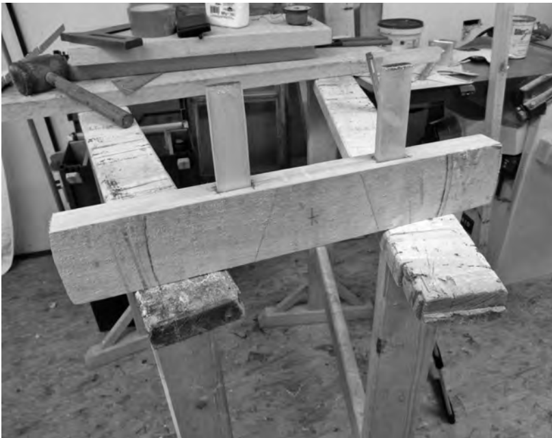
Abb. 20: Anpassung der Flachdübel in die Zapfenlöcher des Mittelteils der Tischplatte (Foto: M. Scheiblecker).
