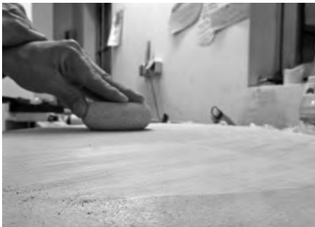
Abb. 27: Finale Bearbeitung der Oberflächen mit dem Bimsstein; hier die Glättung der Tischplatte (Foto: M. Scheiblecker).
