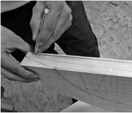
Abb. 21: Anzeichnen der herauszuarbeitenden Form der Tischplatte an einem äußeren Teil; zu sehen ist der erhöhte Rand an der Oberseite sowie die Schalenform an der Unterseite (Foto: M. Scheiblecker).
