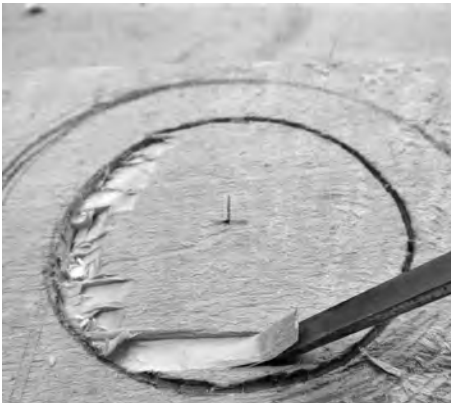
Abb. 24: Ausarbeitung der Durchlochung des Ringes für das Zusammenhalten der Beine (Foto: M. Scheiblecker).
