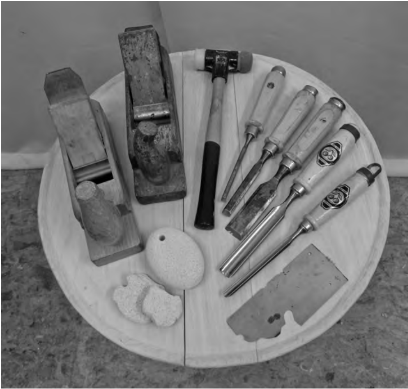
Abb. 18: Die zur Rekonstruktion verwendeten Werkzeuge Hobel, Schlägel, Stecheisen, Stemmeisen, Hohlbeitel, Ziehklinge und Bimsstein (im Uhrzeigersinn) (Foto: M. Scheiblecker).
