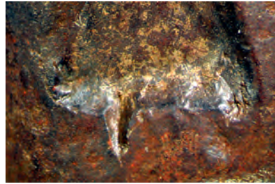
Abb.4: Detailaufnahme des ziselierten Beinbereiches mit darüberliegender Dendritenbildung im Bronzegefüge (Foto G. Jendritzki, VAM-SMB)
