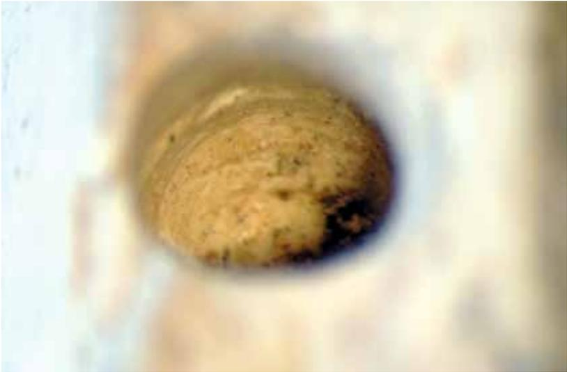
Abb. 5: Bohrloch ohne Korrosionsrückstände (Foto Gert Jendritzki)
